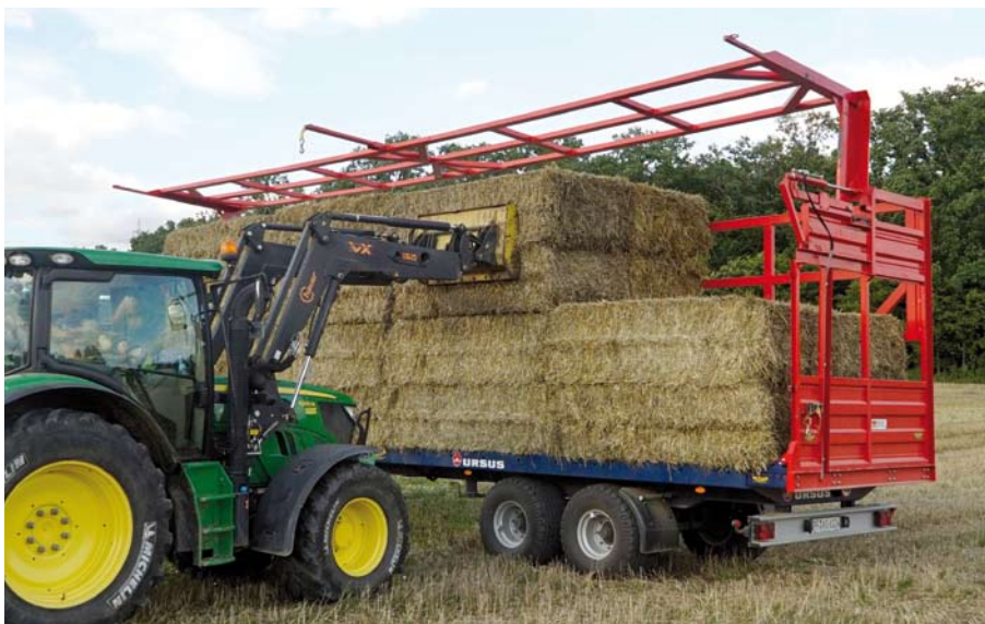
Ballenwagen 18 t mit hydraulischer Sicherung
