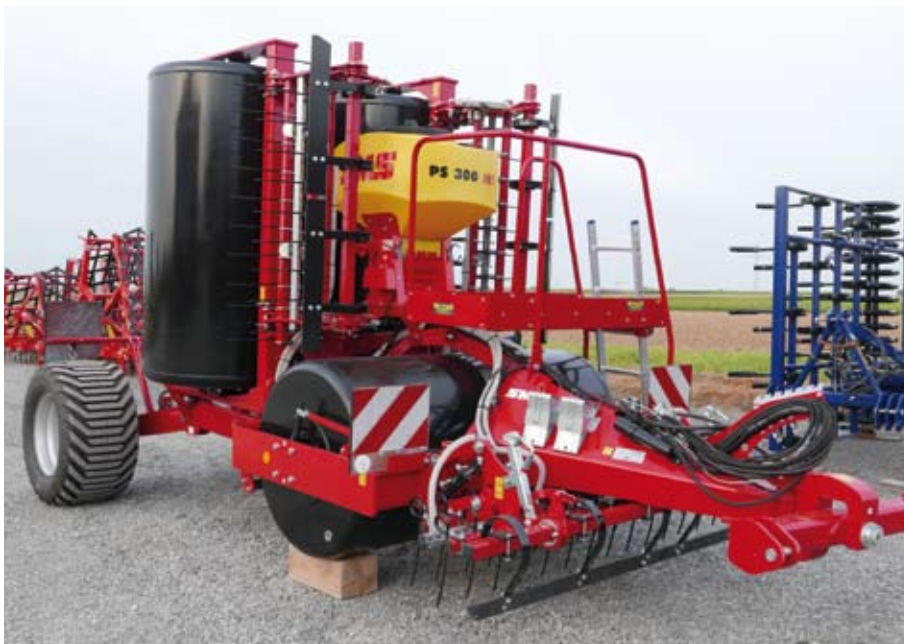
Golem 540 mit Sätechnik, Druckluftbremse und Bereifung 550/45-22,5
