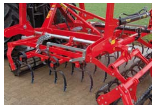
Die Arbeitstiefe wird über das Eggenfeld eingestellt.
