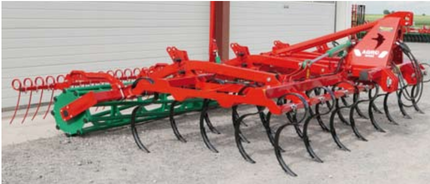
APS 5,0 m mit Schmalscharen, Rohrwalze und Strohstriegel
