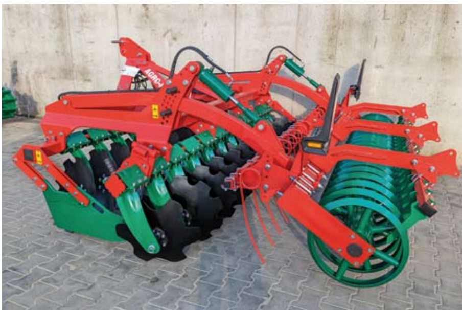
BT 30 (C-Scheibe) mit Dachwalze, Striegel, Randblech und Randscheibe, Beleuchtung
