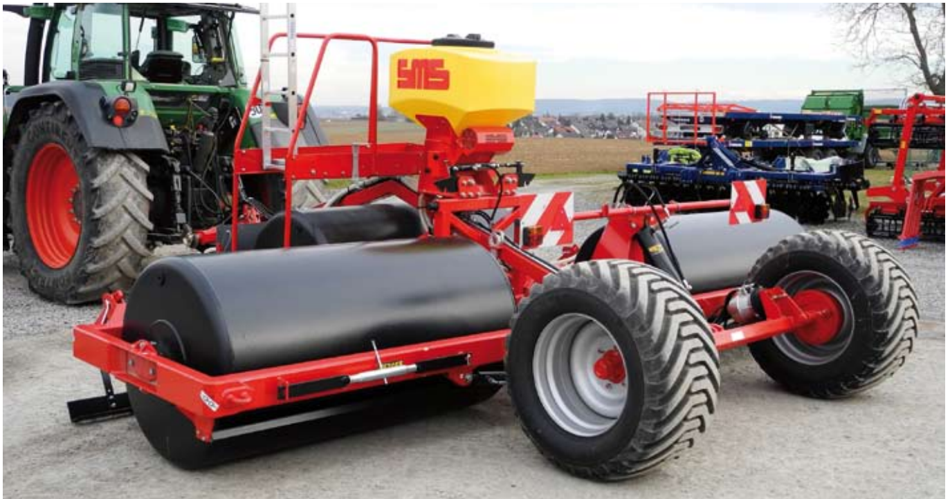
Golem 540 mit Sätechnik, Druckluftbremse und Bereifung 550/45-22,5
