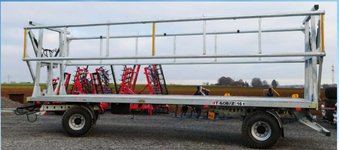
CYNKOMET Ballenwagen 16 t mit hydraulischer Ladungssicherung
