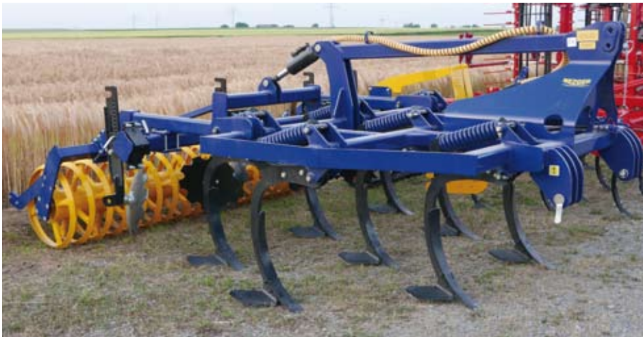
MG 300 gefedert mit Dachwalze (10 Zinken)
